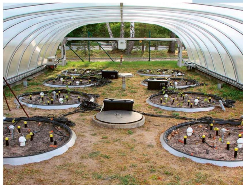
Bei Regen gleitet eine fahrbare Dachhaube über die Setzlinge, damit sie keinem Niederschlag ausgesetzt sind. Wasser erhalten sie genau dosiert über eine Tropfanlage.
